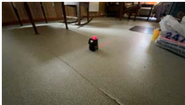
Avviksmåling stue med laser.
