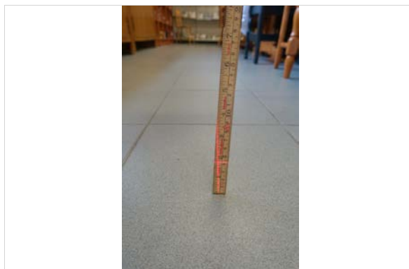
Maks høydeforskjell v/3 m avstand : 18 mm
