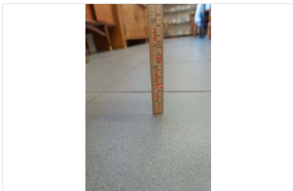
Maks høydeforskjell v/2 m avstand : 12 mm
