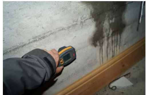
Det er påvist fuktgjennomtrenging inn i kjellermur.
