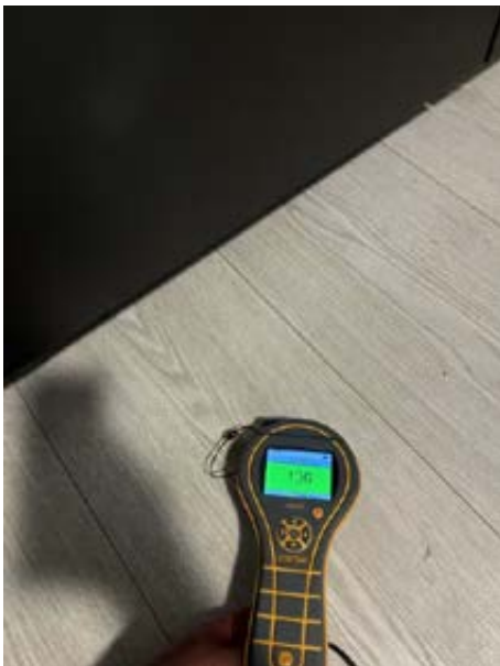
Ingen indikasjon på fukt
