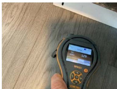
Ingen unormale fuktverdier ved bruk av fuktindikator på gulv ved oppvask.
