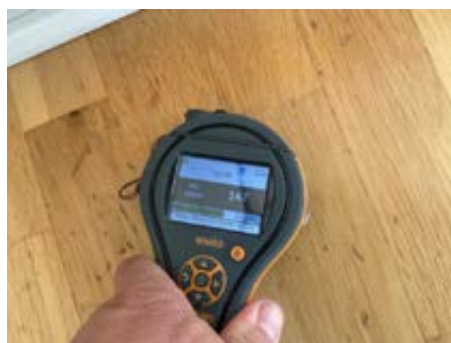
Ingen unormale verdier på gulv ved bruk av fuktindikator nedenfor vask/oppvaskmaskin.
