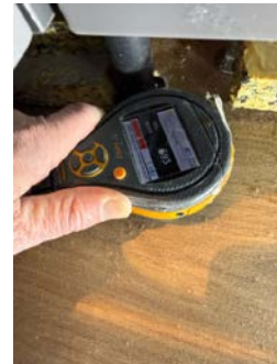
Høye utslag og deformert laminatgulv under kjøleskap
