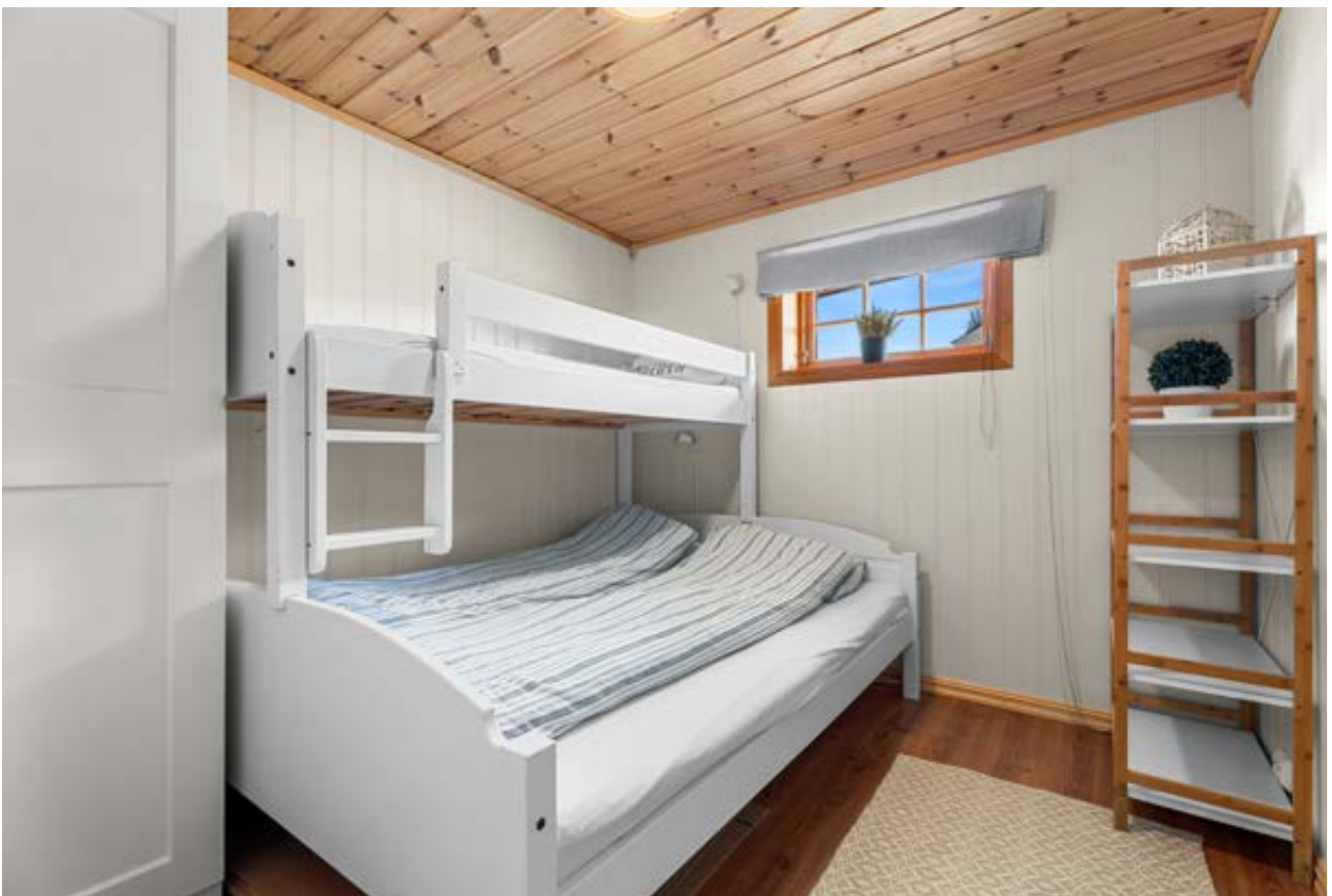
Benyttes som soverom. Ifølge takstmann tilfredsstiller ikke rommet krav til rømning og dagslysflate. Se takstrapport.
