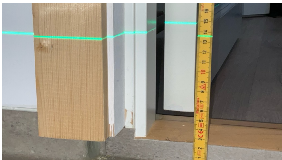
Høyde gulv ved dørterskel. 2 mm over sluk.
