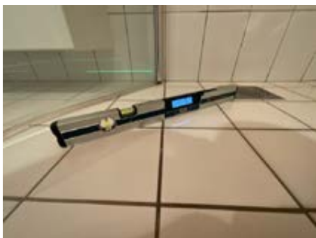
Ca 5 mm per meter fall i denne retningen.
