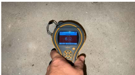
Forhøyde fuktverdier på overflater
