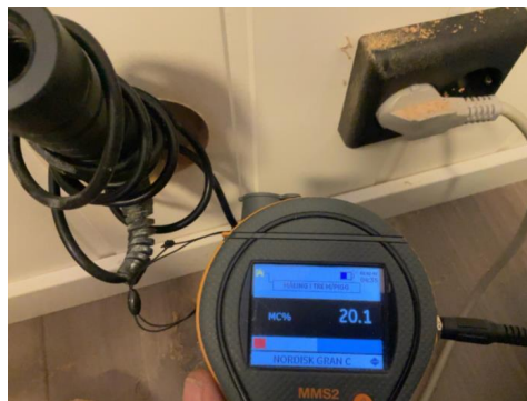
Kontrollmåling på soverom i kjeller viste 20,1 vekt% fukt, som er noe over anbefalte verdier hvor det anbefales under 17 vekt%.
