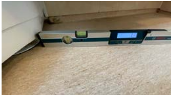
Motfall ved sluk på 1 mm/meter.
