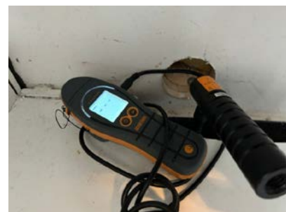
Hulltaking og fuktsøk på ny befaring
