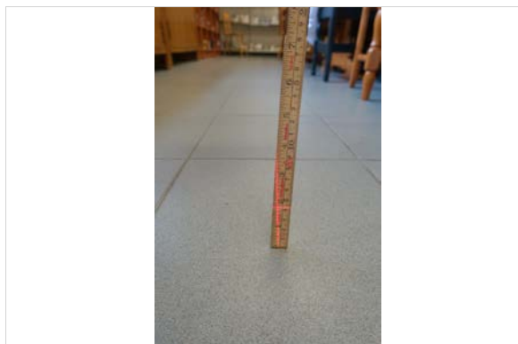
Maks høydeforskjell v/3 m avstand : 18 mm
