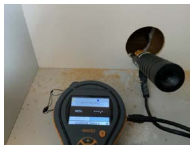
Måling med pigg viste under 7 vekt% ved dagens befaring.
