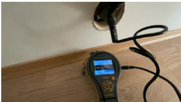
Piggmåling viste under 7 vekt%.
