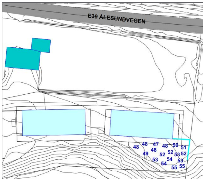
FIGUR 5 Beregnet L_{DEN} på lekeareal 1,5 meter over nytt terreng på K+25. Lokal skjerm øst for nybygg har kotehøyde topp skjerm K+28.
