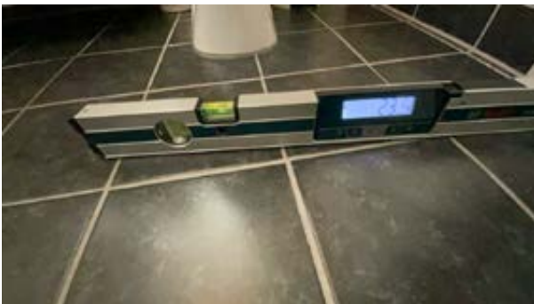
23 mm/meter fall mot sluk på gulv generelt.
