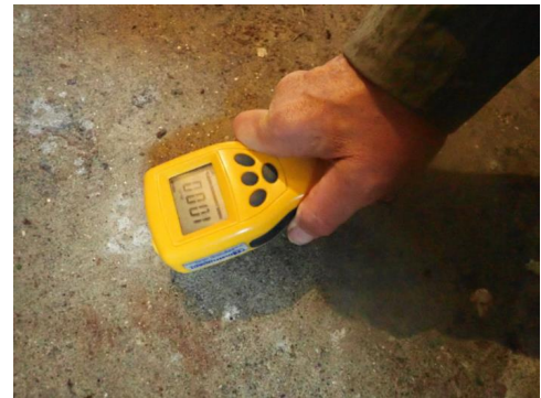
Full fuktindikering på betonggulv. Måleresultatet betegnes som vått.
