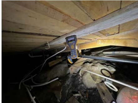
Det er målt 19,3 vektprosent i stubbegulvet.
