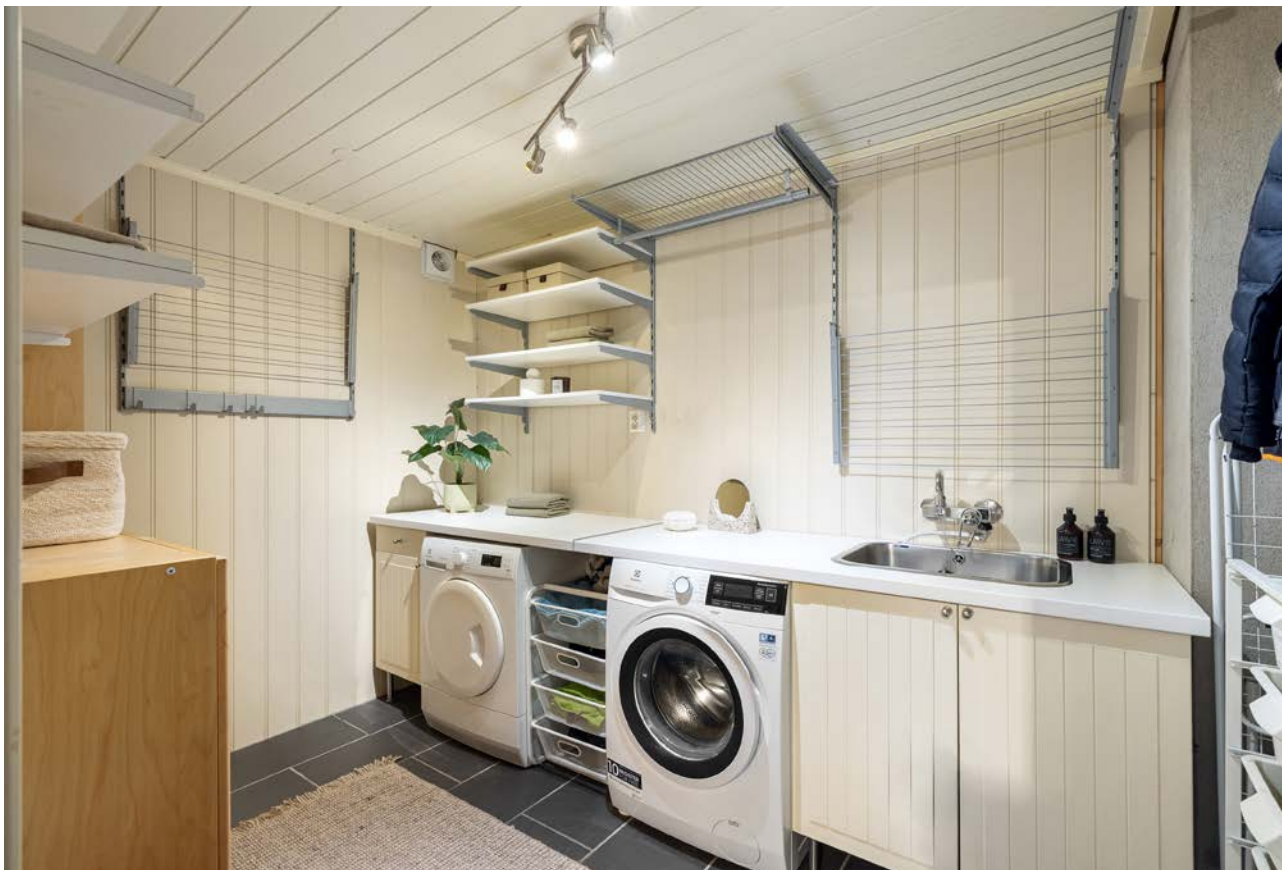
Vaskerommet er på opprinnelig godkjente tegninger betegnet som bod. Rommet er i dag innredet med flislagt gulv med gulvvarme, og det er etablert plass/opplegg for vaskemaskin.
