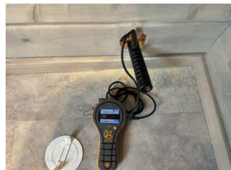
Hulltaking og fuktmåling, ingen fukt eller andre avvik registrert i borehull. Hull blir blendet forsvarlig.
