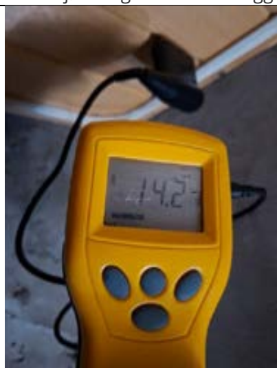
14,2 % i tak-panelet. Kjeller
