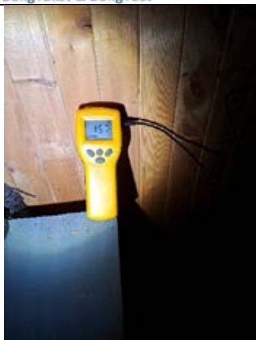
15,7% i utforet panelvegg. Kjeller
