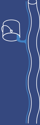
Fig.2 - En flexibel strømpeforing mettes med epoxy
