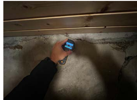
Referansemåling. Utslag på fukt på vegg ned mot gulv, ikke utslag på fukt i øvre del av vegg.
