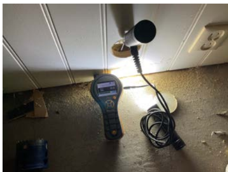
Hulltaking og fuktsøk, ikke utslag på fukt.
