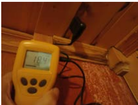
Målt 18% fukt i tak ved pipen på soverom. Synlige fuktmerker i panel og taklis
