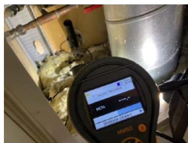
Fuktkontroll ved piggmåling viste under 7 vekt% ved dagens befaring.
