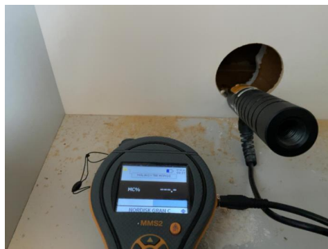
Måling med pigg viste under 7 vekt% ved dagens befaring.
