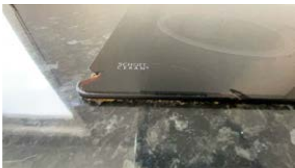
Skader/brudd i overflate på induksjonsstopp.
