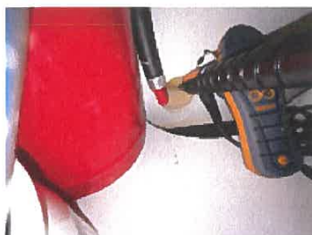
Hulltaking og fuktsøk
