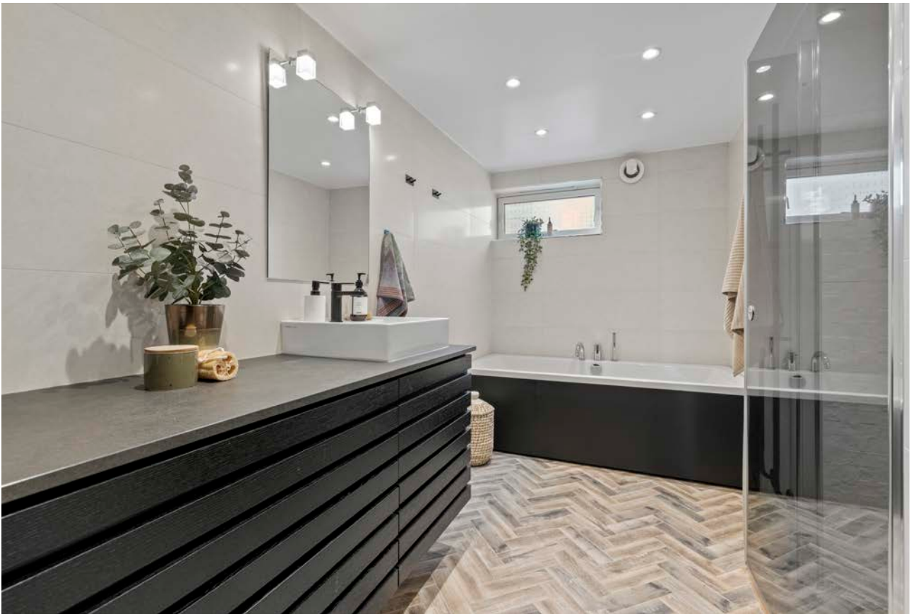
Pent flislagt bad/wc fra 2018 med badekar og dusjnisje med dør i herdet glass. Senket og malt platehimling med LED belysning. Varmekabler.
