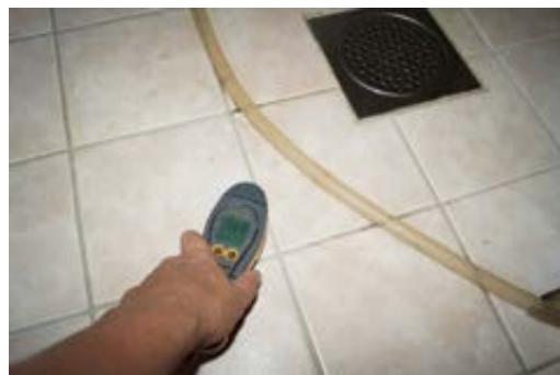
Indikasjonsmålinger er foretatt i de relevante våtsoner ved befarings, uten at det ble påvist indikasjoner på fuktskader.
