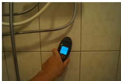
Indikasjonsmålinger er foretatt i de relevante våtsoner ved befarings, uten at det ble påvist indikasjoner på fuktskader.
