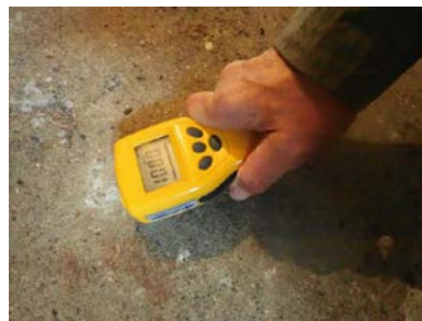
Full fuktindikering på betonggulv. Måleresultatet betegnes som vått.
