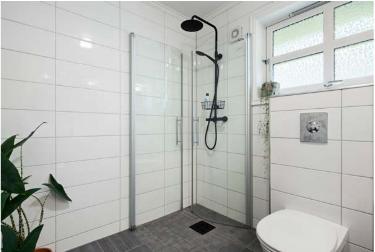
Badet er utstyrt med varme i gulv, dusjhjørne, vegghengt wc -
