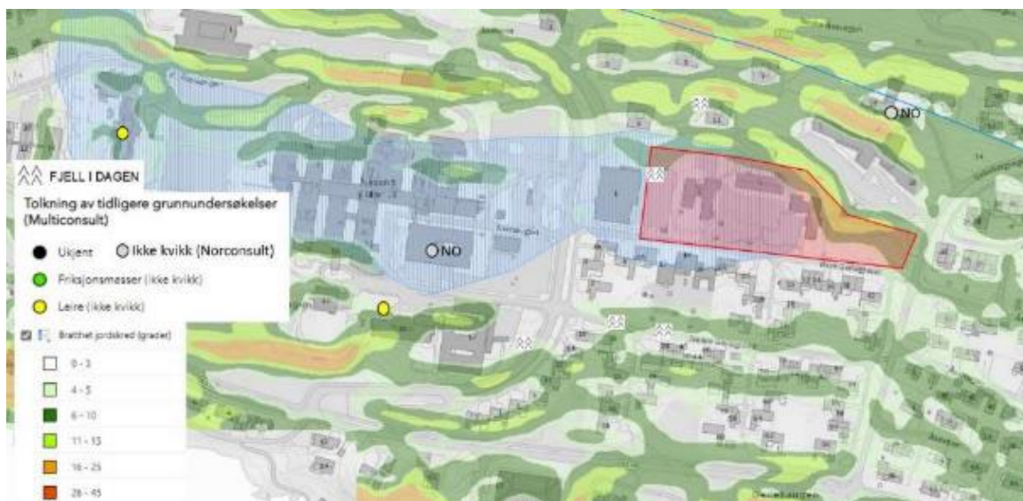
Figur 29. Utklipp som viser omtrentlig omriss av tiltaksområdet sammenstilt med kart for terrenghelning, tidligere grunnundersøkelser, bergblotninger og aktsomhetsområde for marin leire.
