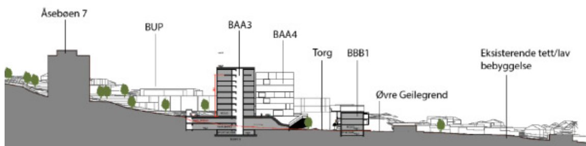
Figur 57: Terrengsnitt gjennom det høyeste punkthuset BAA3, sett mot øst. Illustrasjon: Bo arkitekter AS/ Norconsult AS.
