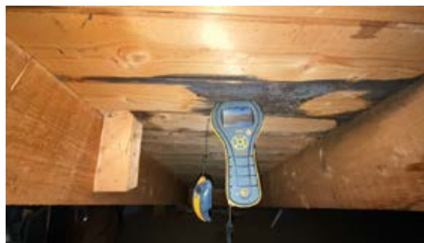
Måling av fukt i fuktskjolde. Her ble det ikke funnet unormal fuktverdi.
