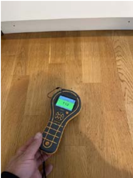
Ingen indikasjon på fuktighet i/rundt kjøkken
