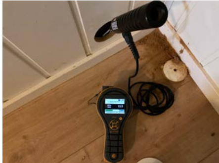
Hulltaking og fuktmåling, ingen fukt eller skader påvist.
