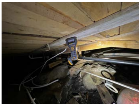
Det er målt 19,3 vektprosent i stubbegulvet.
