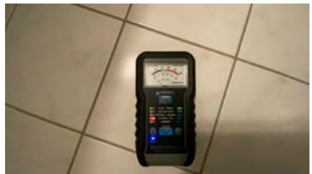
Fuktsøk viste ingen forhøyede verdier
