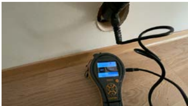
Piggmåling viste under 7 vekt%.
