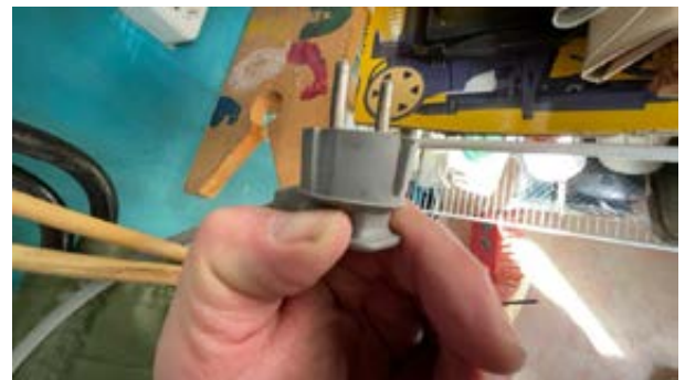
Ingen svimerker på stikk ved dagens befaring.
