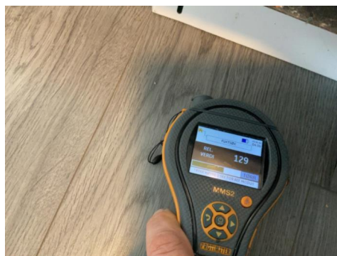
Ingen unormale fuktverdier ved bruk av fuktindikator på gulv ved oppvask.
