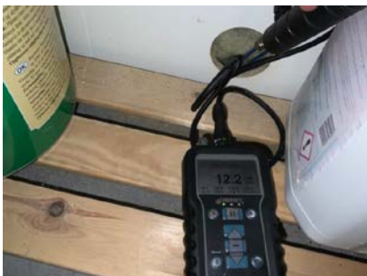
Hulltaking i rom under terreng med 12% (tørt).
