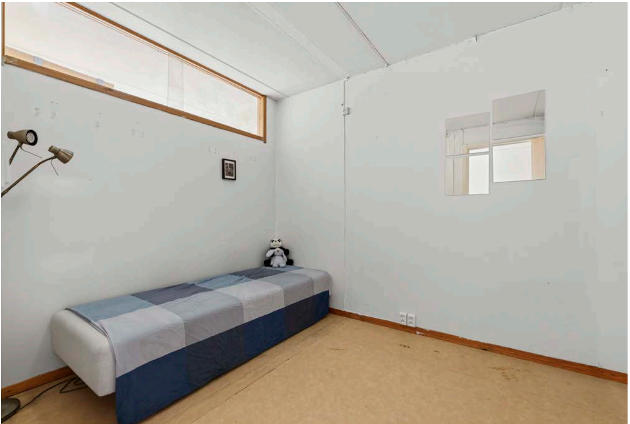
Innvendig bod innredet som sovealkove. Rommet har ikke vindu ut og vil ikke bli godkjent som soverom.
