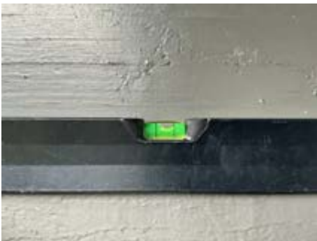
Ved nivellering med vader er det registrert en høydeforskjell på 13 mm.
