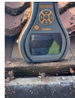
Fuktmåling viser 31,3 vektprosent
