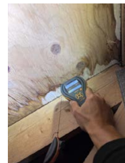
Fuktmåling viser 31,3 vektprosent
