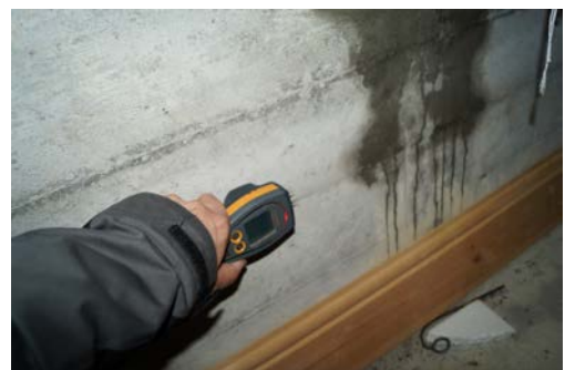
Det er påvist fuktgjennomtrenging inn i kjellermur.
